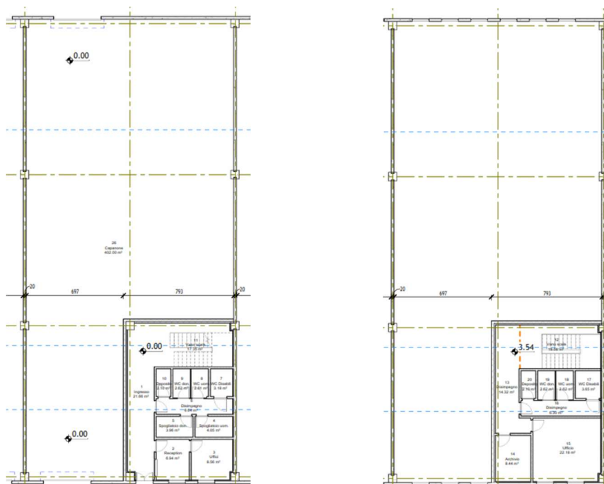
Figura 2 Modulo A Pianta piano terra e primo
